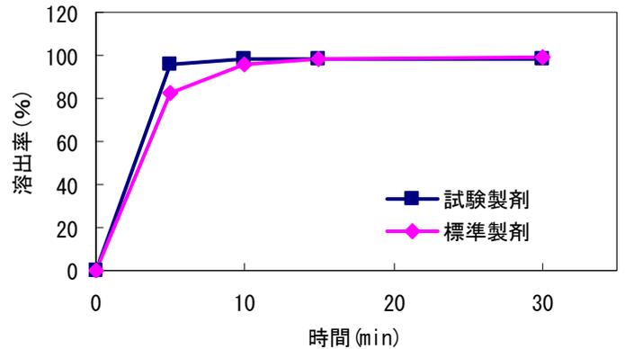
図3 パドル法(50rpm)試験液「pH6.8」における試験製剤及び標準製剤の溶出挙動
