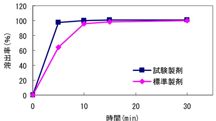
図5 パドル法(100rpm)試験液「pH1.2」における試験製剤及び標準製剤の溶出挙動
